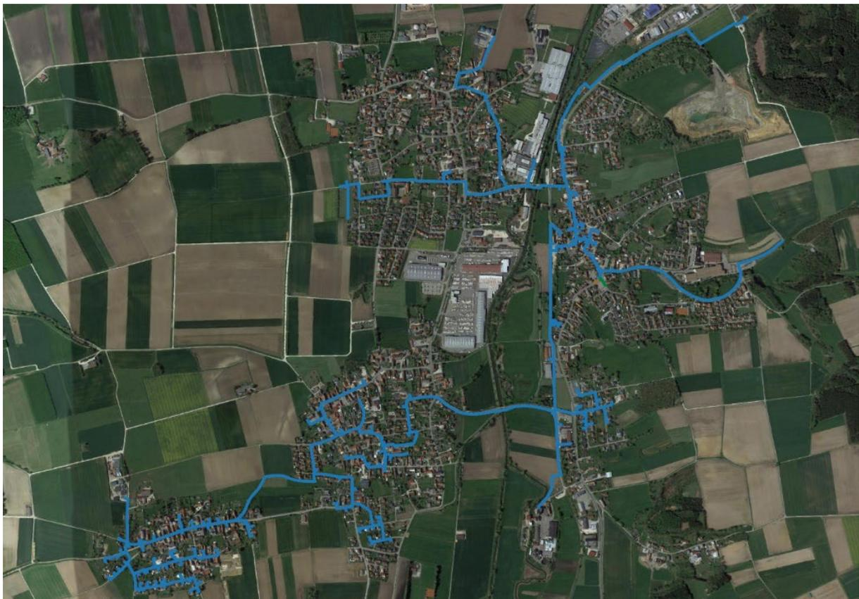
BU: Das Nahwärmenetz (blau) in Buttenwiesen ist inzwischen auf eine Länge von rund 20 Kilometer angewachsen.
