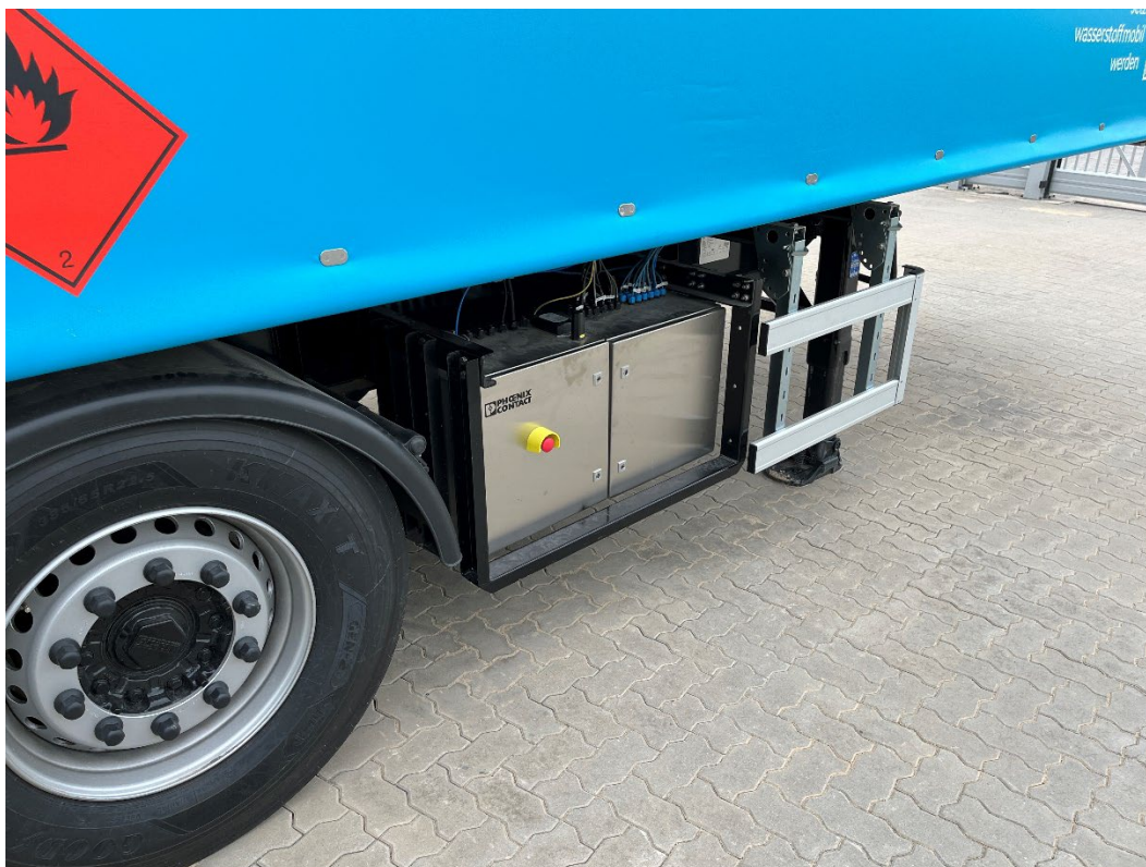
BU: So sieht sie aus: Die smarte Technik wird in einem 100x50x28 cm großen Kasten direkt am Trailer installiert.
